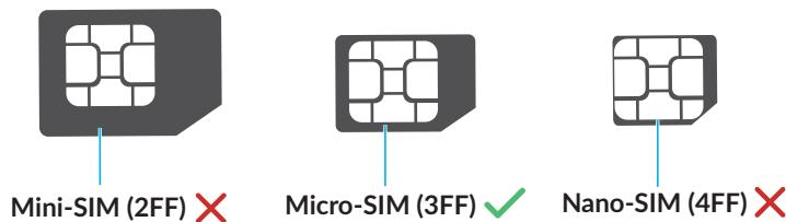
找到 Micro SIM 卡插槽，並插入一張 Micro SIM 卡，如下圖所示。插入卡後，關閉 Micro SIM 卡槽蓋。
